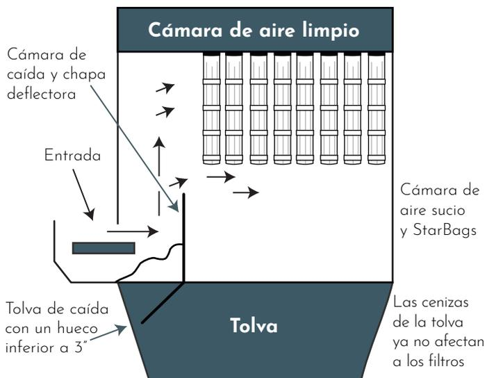
La presión diferencial se ha mantenido un 30 % más baja a la de los filtros convencionales, mientras que el flujo de gases se ha mantenido igual a los filtros convencionales. No se han necesitado intervenciones de mantención correctiva no planificadas para solucionar la abrasión de los filtros y las emisiones se han mantenido por debajo del límite autorizado.
